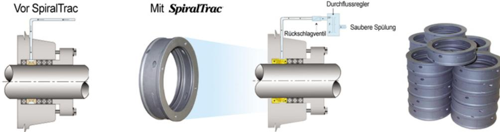
Reduzierte Spülung • Nur zur Verwendung mit Packung • Keine konstruktiven Veränderungen erforderlich
