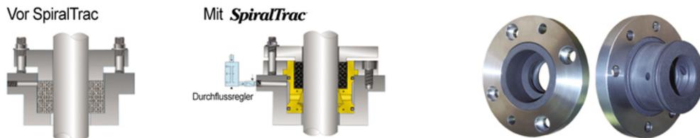
Reduzierte Spülung • Nur zur Verwendung mit Packung • Keine konstruktiven Veränderungen erforderlich
