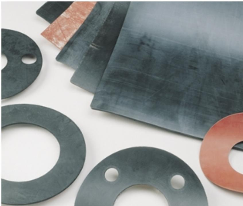
Chesterton **100** ist eine hochwertige Styrolbutadien-Gummitafeldichtung mit glatter Oberfläche, die weich und verformbar bleibt. Typ 100 eignet sich besonders für niedrigen Druck oder gesättigten Dampf, Heiß- oder Kaltwasser, Ammonium und milde Laugen.
