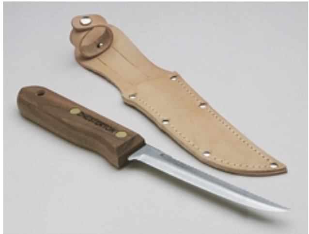
Das Chesterton Packungsmesser 174 hat eine leicht angefaste Klinge zum Schneiden geflochtener Packungen und eine Sägeklinge zum Schneiden formgepressten Materials. Die Klingenslänge ist 125 mm (5 Zoll); die Gesamtlänge mit Scheide 250 mm (10 Zoll).
