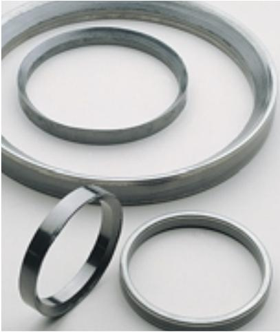
Chesterton Hochdruck-Ventildeckeldichtungen 5900 bieten dem Anwender in Kraftwerken verbesserte Zuverlässigkeit und Sicherheit gegen Leckage bei Ventildeckel-Druckverbindungen. Diese neuen Hochdruck-Ventildeckeldichtungen sind zum Einsatz in Ventilen mit verschraubten Ventildeckeln in Wasser- und Dampfanwendungen vorgesehen. Die Hochdruck-Ventildeckeldichtungen 5900 sind auch mit Metallendkappen erhältlich.
