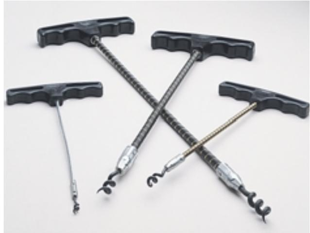
Chesterton flexible Packungszieher 253 sind für das Ausziehen von Packungen mit großer Kraft ausgelegt. Konstruktionsmerkmale sind hochfestes Flugzeugbauseil, präzise wärmebehandelte Extraktionsschraube und nicht brechbare drehgeschmiedete Spitzen. Die Gewindespitzen sind mit einer Kunststoff-Schutzschicht überzogen. Der Griff ist groß und ergonomisch ausgeführt. Lieferung in Sätzen von 4 Werkzeugen.
