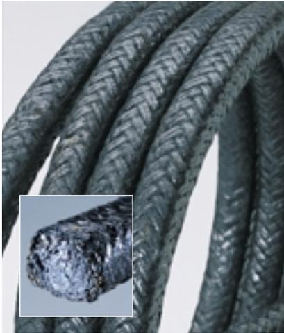
CHESTERTON 401 besteht aus drahtverstärktem, geflochtenem Garn um einen flexiblen und widerstandsfähigen, asbestfreien Kern. Diese einzigartige asbestfrei ummantelte Garnbauweise umfasst die Drahtverstärkung im Garn und verhindert Spindelverschleiß und Riefenbildung. Diese einmalige Bauweise macht den Typ 401 zu einer wirtschaftlichen, asbestfreien Ventilspindelpackung für allgemeinen Einsatz bei hohen Temperaturen und hohem Druck.
