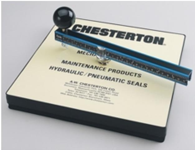
Der Chesterton Dichtungsschneider 179 versetzt den Benutzer in die Lage, Anforderungen zum Schneiden von flachen Flanschdichtungen bis zu 12 mm (1/2 Zoll) Stärke und Durchmessern zwischen 30 (1-3/16 Zoll) bis 500 mm (20 Zoll) anhand der leicht ablesbaren metrischen und Zoll-Radiusskala schnell zu erfüllen.
