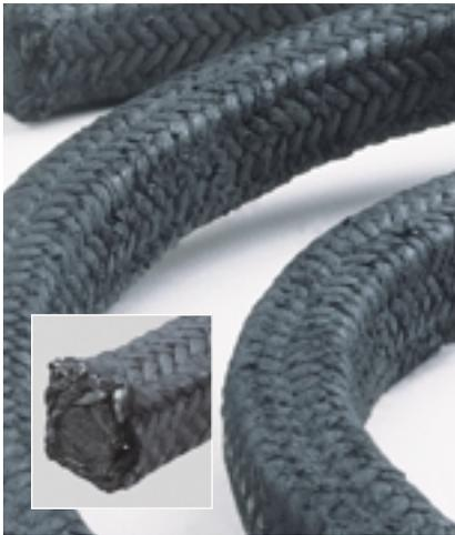
Einzigartige Kohlenstoff- und Graphitausführung sorgt für werksweiten Einsatz von einer Spule. Chesterton 370 wird aus einem qualitativ hochwertigen Kohlenstoffgarn hergestellt, sie enthält Teilchen aus reinem Graphit, Hochtemperaturöle und MoS<sub>2</sub>, die als lebenslange Blockiermittel wirken. Der reibungsarme Kohlenstoffgarn ist in nicht oxidierenden Umgebungen ausgezeichnet für hohe Temperaturen geeignet.
