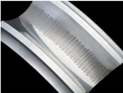
Spannungen, die sich über die Lager entladen, können Riffelungen auf der Lagerlaufbahn verursachen, was zu einem vorzeitigen Ausfall des Lagers führt.
