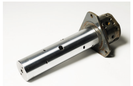
Drehdurchführung schleifen, hartverchromen
